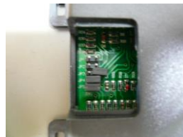
左の写真はJP3がオープンで JP4、JP5がショートの場合 (JP1、JP2のみ使用)
