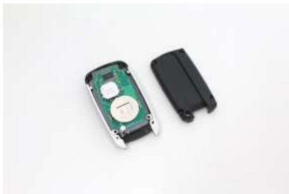
⑤裏蓋を外して電池を交換します。
