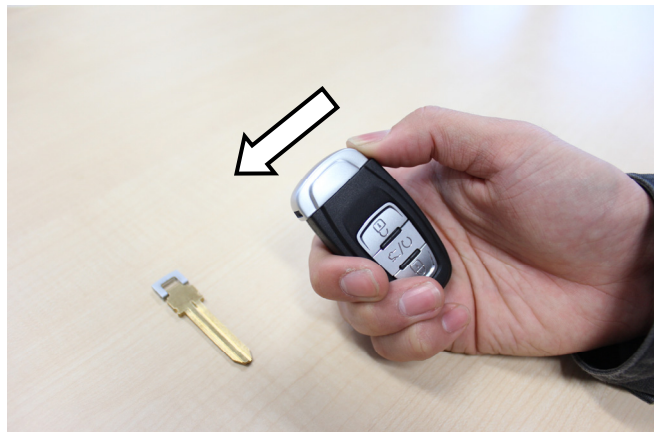
②銀色の部分を押しながら横にスライドさせて、外します。
