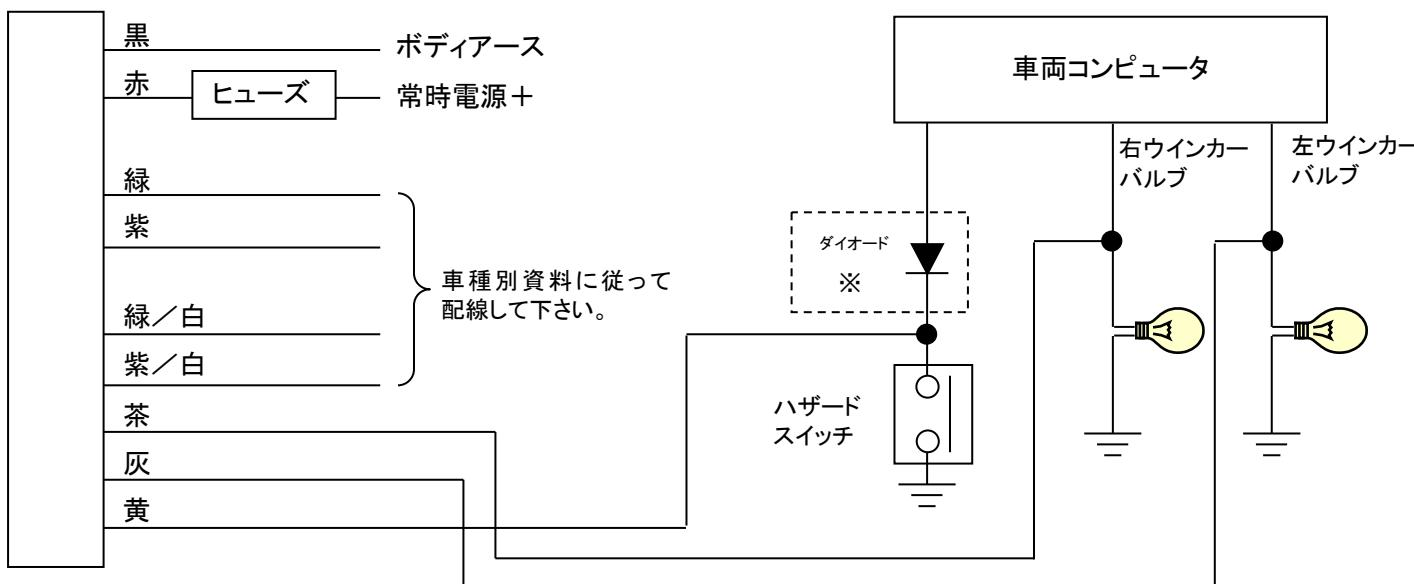
※ ハザードが点滅し続ける症状が出る場合は、図のように車両の線を切断した途中にダイオードを入れて下さい。
